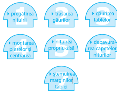
Fig.5.2. Fazele nituirii manuale
