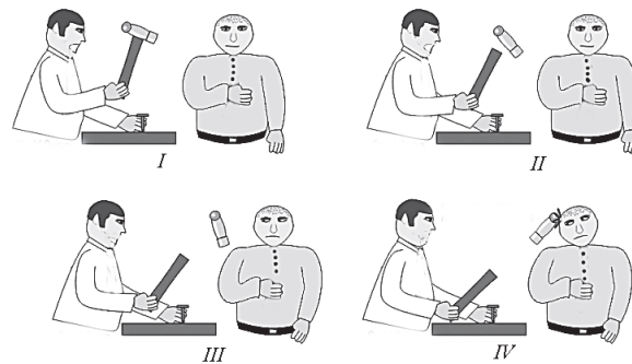
Fig. 5.8. Utilizarea necorespunzătoare a ciocanului
